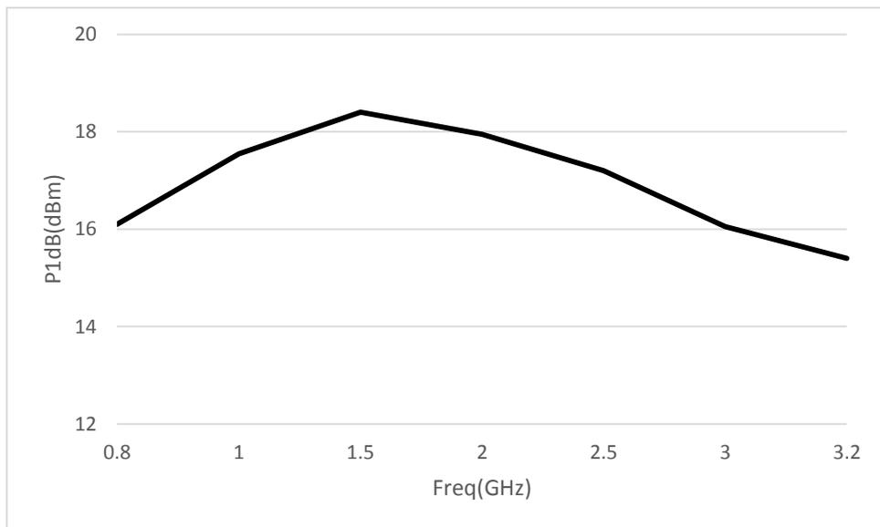
1dB 压缩输出功率 vs 频率
